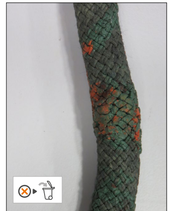
• Rastro de pintura
